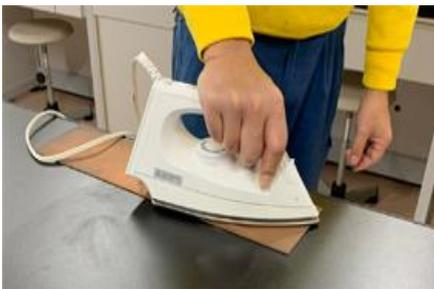
図. パターンを銅箔面に転写する
