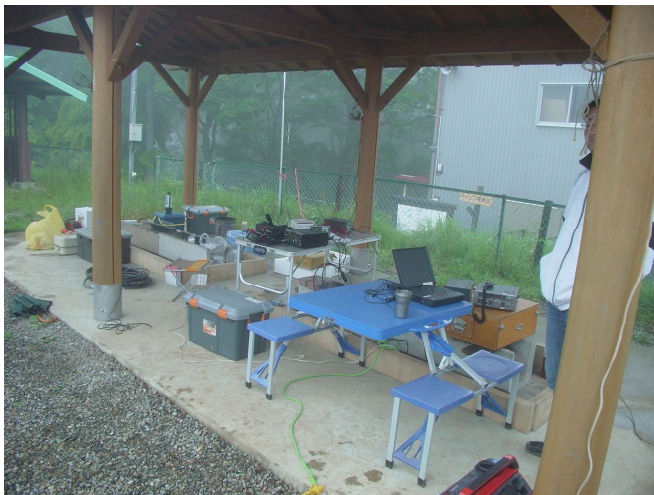
BBQ用東屋にメインシャックを設置 手前：TS-680V (HF帯10W、主に7MHzで使用) 中央：IC-375 (430MHz帯10W) 奥：ID-1 (1200MHz1W)
