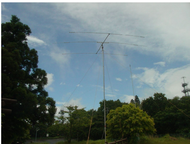
1. 9/3. 5MHz用逆Vと、14～28MHz用ローテータ付き3エレ (TA-10-15JrにTA-33Jrの輻射器を移設)
