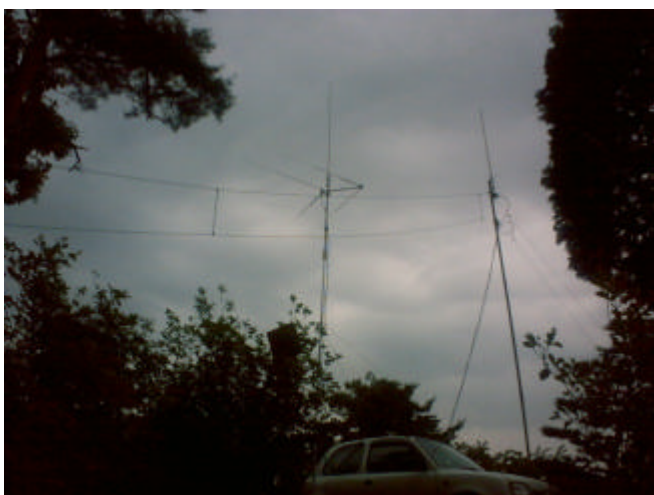
【写真左】 JL20GZ/2のAnt群 左側：1200MHzのGPと50MHzの2ele 右側：144/430MHzのGPとHFのT2FD 全長25mのT2FDを初めて使いましたが、全長10mのもの比べて多少飛びは良いものの、ローバンドはやっぱリダミーロード状態でした(泣)。
