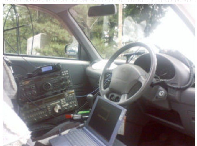
【写真右】 JL20GZ/2のシャック 上から順に FT-100M (50/144/430MHz用) FT-1011 (HF用) FT-736M (1200MHz用) 車の助手席に無線機、運転席でオペレートという体勢はちょっとつらかったです。 de JL20GZ/2
